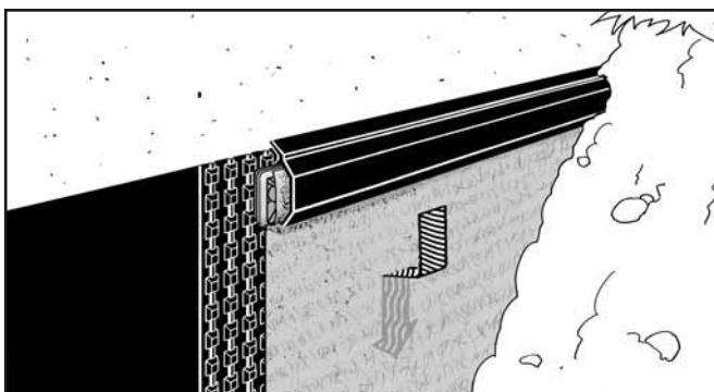
**Platon Double Drain™** filtre et draine l'eau du sol.
