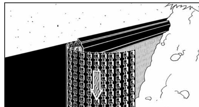
**Platon Double Drain™** évacue l'eau de fuite éventuelle librement au moyen de **canaux de drainage verticaux**. Les canaux de drainage évitent ainsi la création d'eau stagnante permanente contre l'étanchéité.
