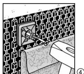
③ Fixation de la membrane **Platon Double Drain™** :
